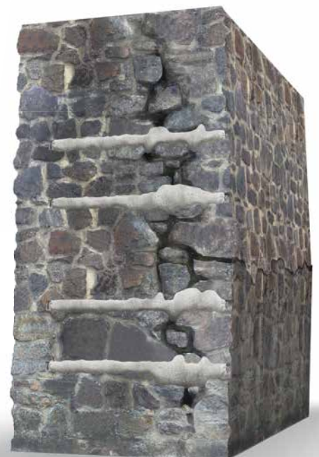
Anbindung abgelöster Mauerwerkschalen Connection of separated wythes
