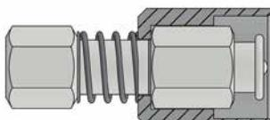
Sicherung gegen die Druckfeder zurückdrücken
