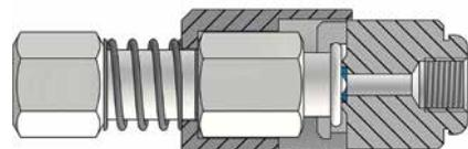
Schiebekupplung auf den Flachkopfnippel aufschieben
