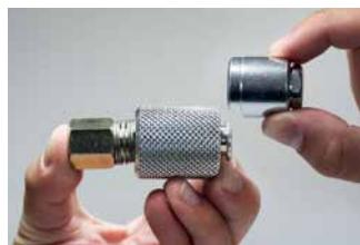
Schiebekupplung auf den Flachkopfnippel aufschieben | Slide the sliding coupling onto the pan head nipple
