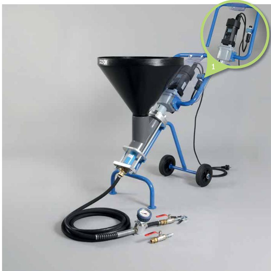
1. Stufenlose Fördermengenregulierung | Infinitely variable delivery rate regulation
