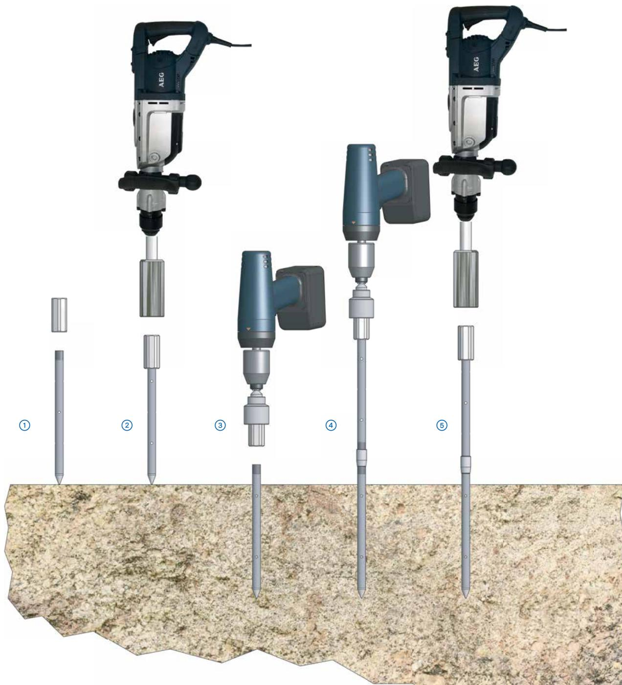
Bodeninjektion mit Rammverpresslanzen: Rammverpresslanze M10x1 (Ø 10 mm)
