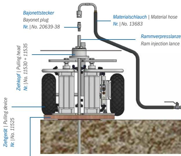
Abstreifplatte & Auflageplatte | Scraper plate and supporting plate
