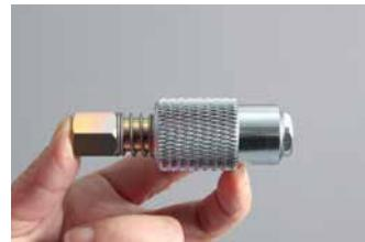
Sicherungskupplung mit Schiebekupplung
