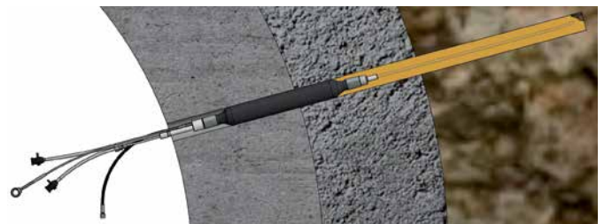
Gespannter Blähpacker mit Entlüftung nach der erfolgreichen Injektion Clamped inflatable packer with ventilation after successful injection
